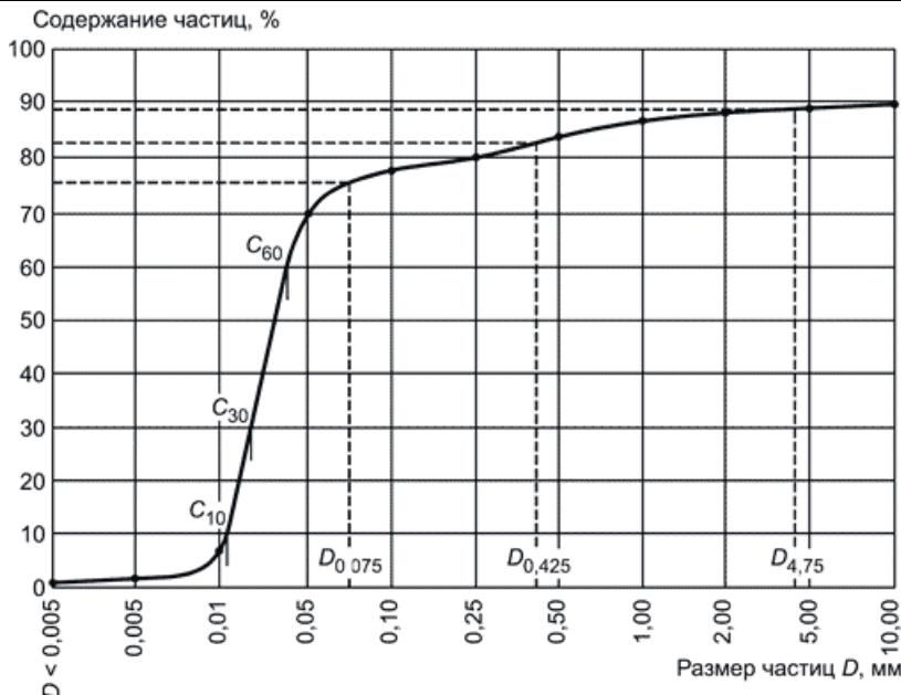
Рисунок E.2 - Кумулятивная кривая гранулометрического состава
